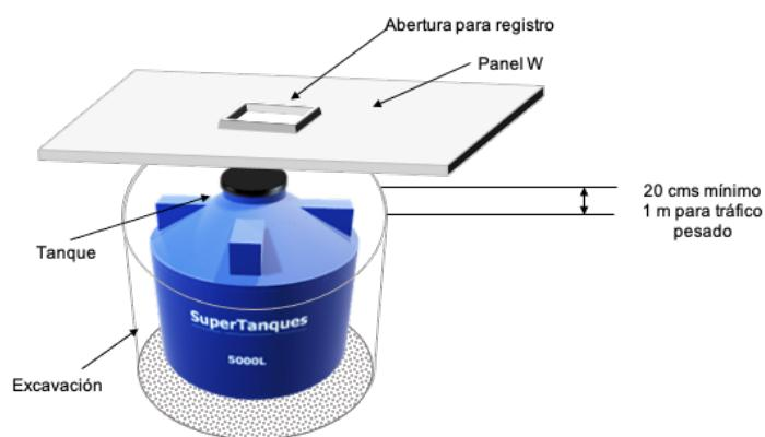
**Importante:** El área circundante inmediata de la excavación NO es apta para el paso de vehículos o para transito peatonal constante. No deben provocarse impactos mecánicos en las inmediaciones del terreno donde se lleve a cabo la instalación del tanque.
