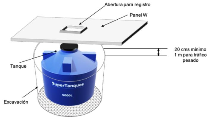
**Importante:** El área circundante inmediata de la excavación NO es apta para el paso de vehículos o para tránsito peatonal constante. No deben provocarse impactos mecánicos en las inmediaciones del terreno donde se lleve a cabo la instalación del tanque.
